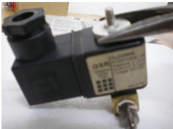
(四) 将排水阀从三轴主机上取下，将上部的手旋螺母拧下（如拧不动可使用钳子）
