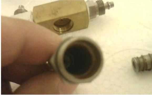
排水阀管路一端字母为 P 一端为 A，其中 P 端连接到压力室，A 端连接到排水传感器。注意图
