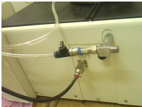
(三)打开“自控状态表”或按住控制器上的排水键，使排水阀处于打开状态，听有无声音。
